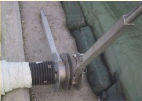
Abb. 13: Ratschenmechanismus zum effektiven Ab- und Aufrollen der Silofolie. ((Bildnachweis:)) Hansjörg Nußbaum, LAZBW
