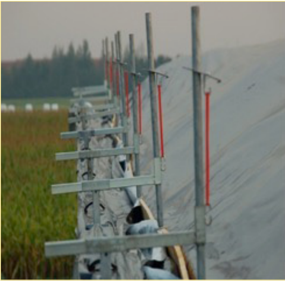
Abb. 12: Beispiel eines Abdecksystems mit Spannbügeln; System nach Duhamel. ((Bildnachweis:)) Hansjörg Nußbaum, LAZBW
